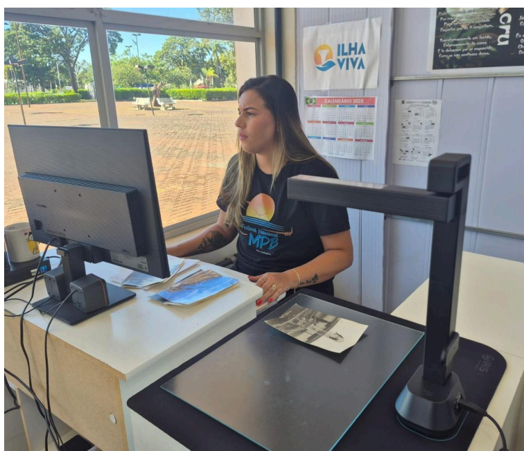
Computador e scanner planetário adquirido pelo projeto. Este scanner degrada menos o documento fotografado por não se tratar de uma varredura de luzes altamente fortes e, sim, de uma captação parecida com uma câmera fotográfica.
